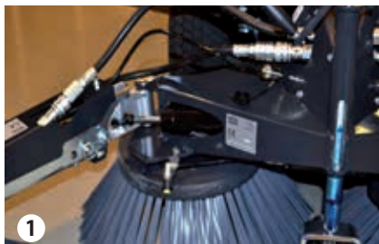
Zakładanie przewodów hydraulicznych + przewodów wodnych na ramię A
