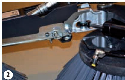
Zakładanie przewodów hydraulicznych + przewodów wodnych na szczotkę boczną
