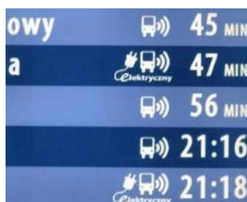
Rys. 7.1 Dynamiczna informacja pasażerska z wyszczególnieniem pojazdów elektrycznych
